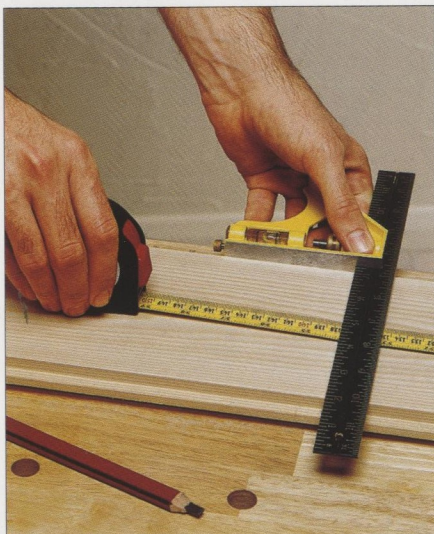
Boven Gebruik een combinatiehaak als blokhaak of als meetlat.
